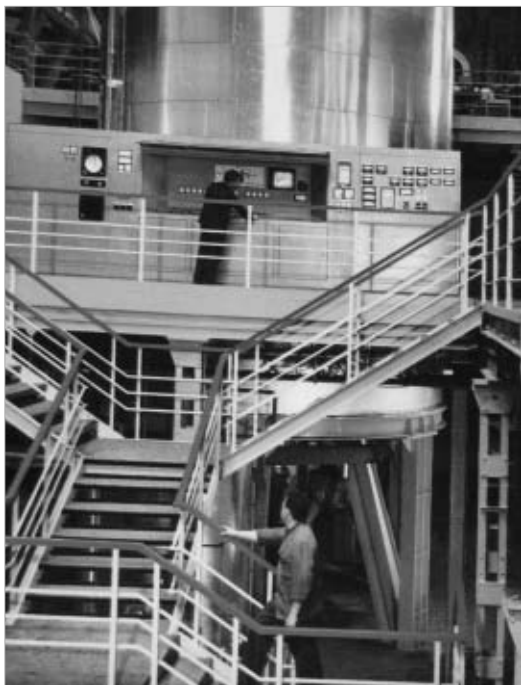
(Oben) Diffusionsturm (Durchmesser 6,25 m, Höhe 15 m) für die Auslaugung des Zuckers aus den Rüben (Rechts) Packstation
