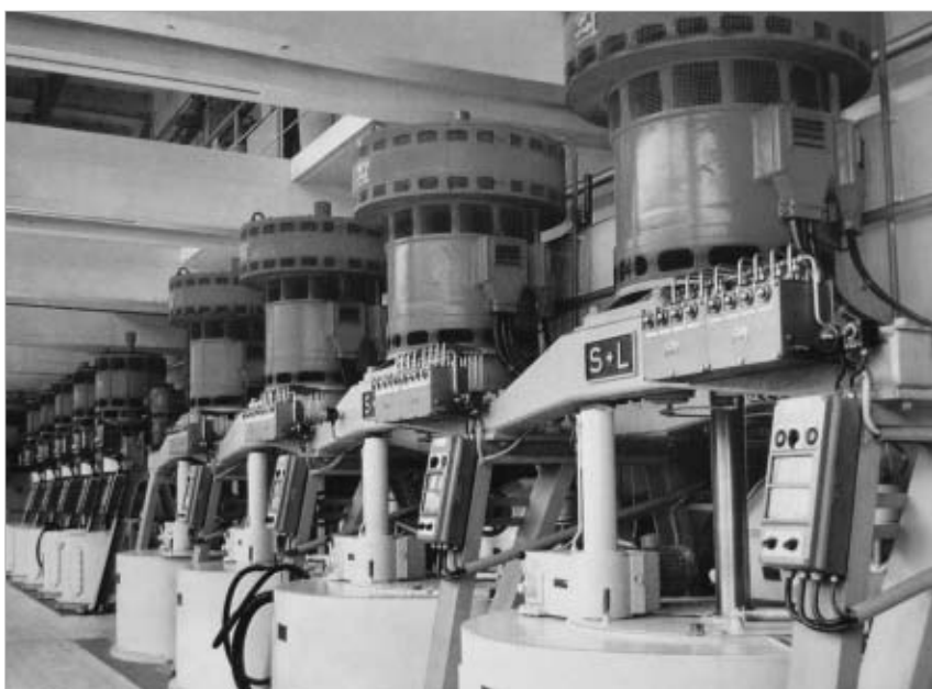
Teilansicht der vollautomatischen Zentrifugenstation nach ihrer Installation (oben) und bei der Demontage 1988 (unten)
